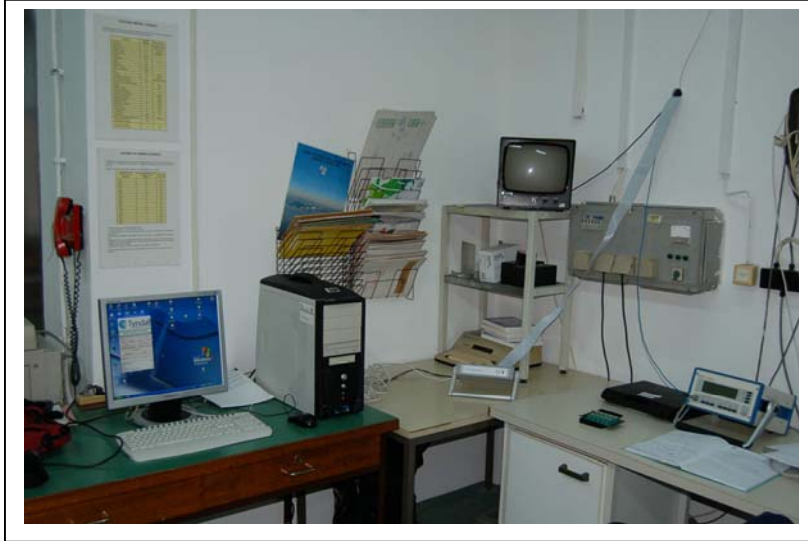
Slika 3.10. MESY2014: Merna jedinica prikuplja izmerene vrednosti sa MOSFET komponenti, i prosleđuje ih na statističku obradu odgovarajućim softverom koji je instaliran na računaru.
