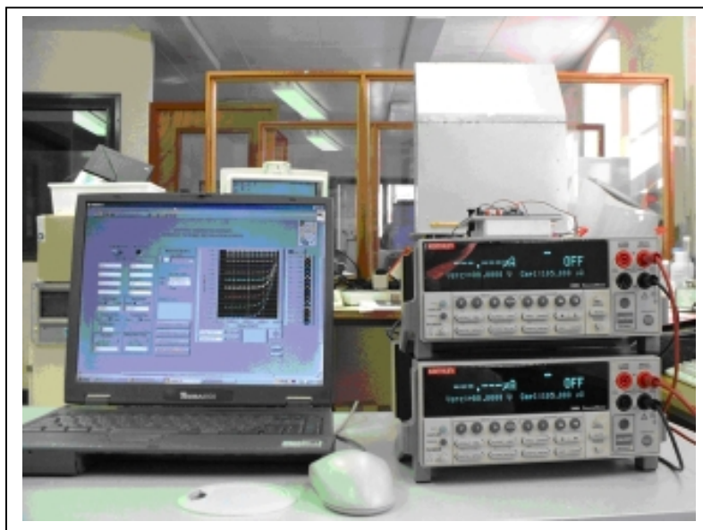
Slika 3.9. MESY2002: softverska podrška na laptopu, uređaj za test elektronskih Komponenti, dva Keithley 2400 SourceMeter.
