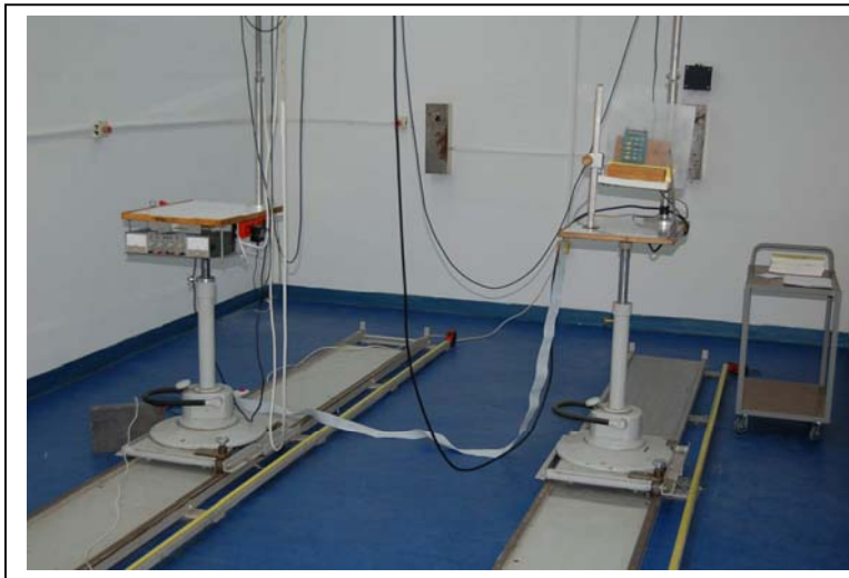
Slika 3.11. MESY2014: deo sistema je konstituisan tako da postoji nosač komponenti koji je povezan na mernu jedinicu, a na njemu se postavljaju ispitni uzorci u polju zračenja.
