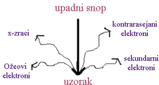
Slika 5.7. Posle interakcije elektrona sa površinom uzorka, dolazi do emisije sekundarnih elektrona, kontrarasejanih elektrona, x-zraka i Ožeovih elektrona iz materijala uzorka.
