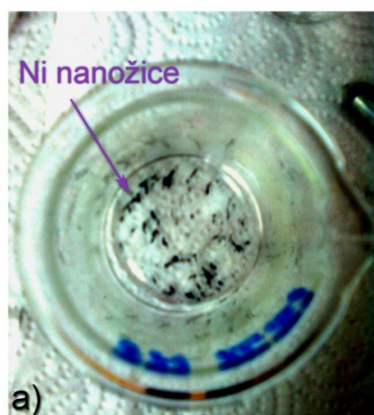
Slika 7.5. a) Crne Ni žice posle oslobađanja od filtera; b) pod uticajem magneta, moguće je kontrolisati niklene nanožice.
