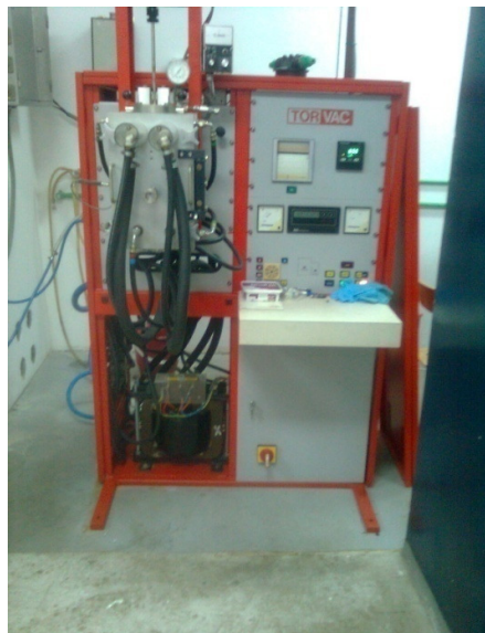
Slika 7.7. Fotografija TorVac sistema za odgrevanje uzoraka u Laboratoriji 030 u Institutu za nuklearne nauke "Vinča".
