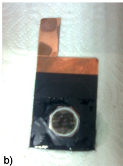
Slika 7.4. a) Whatman anodiskovi bele boje pre elektrolize; b) anodisk zalepljen na bakarnu pločicu ima crnu boju posle elektrolize.
